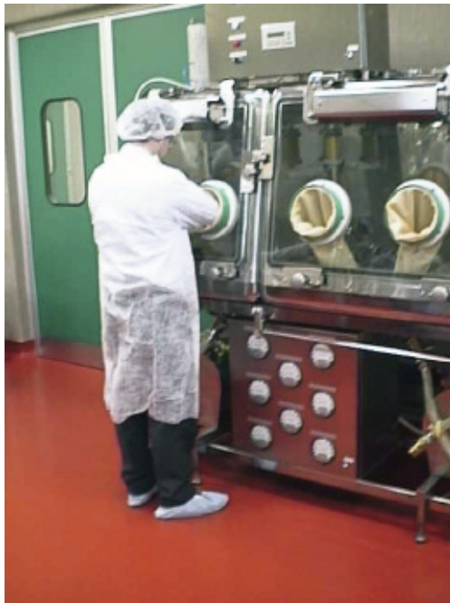
Figura. 22 - Foto di un isolatore
